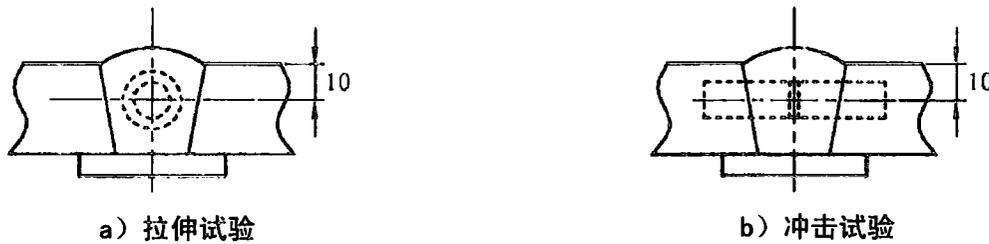
图1 力学性能试验取样位置
